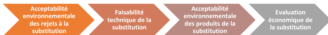
Figure 31 : Processus d'évaluation de la faisabilité de l'utilisation des rejets miniers comme granulats alternatifs
